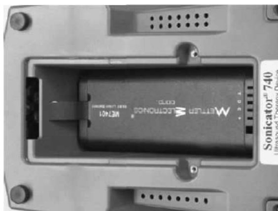
Rycina 3.5 —Instalacja baterii
