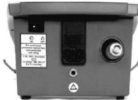
Rycina 4.2 Połączenia do terapii kombinowanej – złącze o kształcie banana oznaczono symbolem \triangle .
